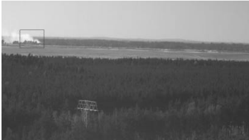
Abb10. Digitale Aufnahme vom Feuerwachturm Kathlow, mit detektiertem Feuer im kleinen Rahmen (Uhrzeit 16:52, Feuer in Plot IV, nachlassende Rauchbildung in I und II).
