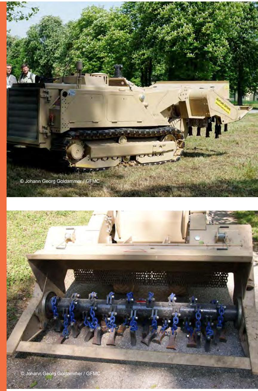
Рис. 1.1. Приклад безлітного трактора призначеного для проведення розмінування території.
