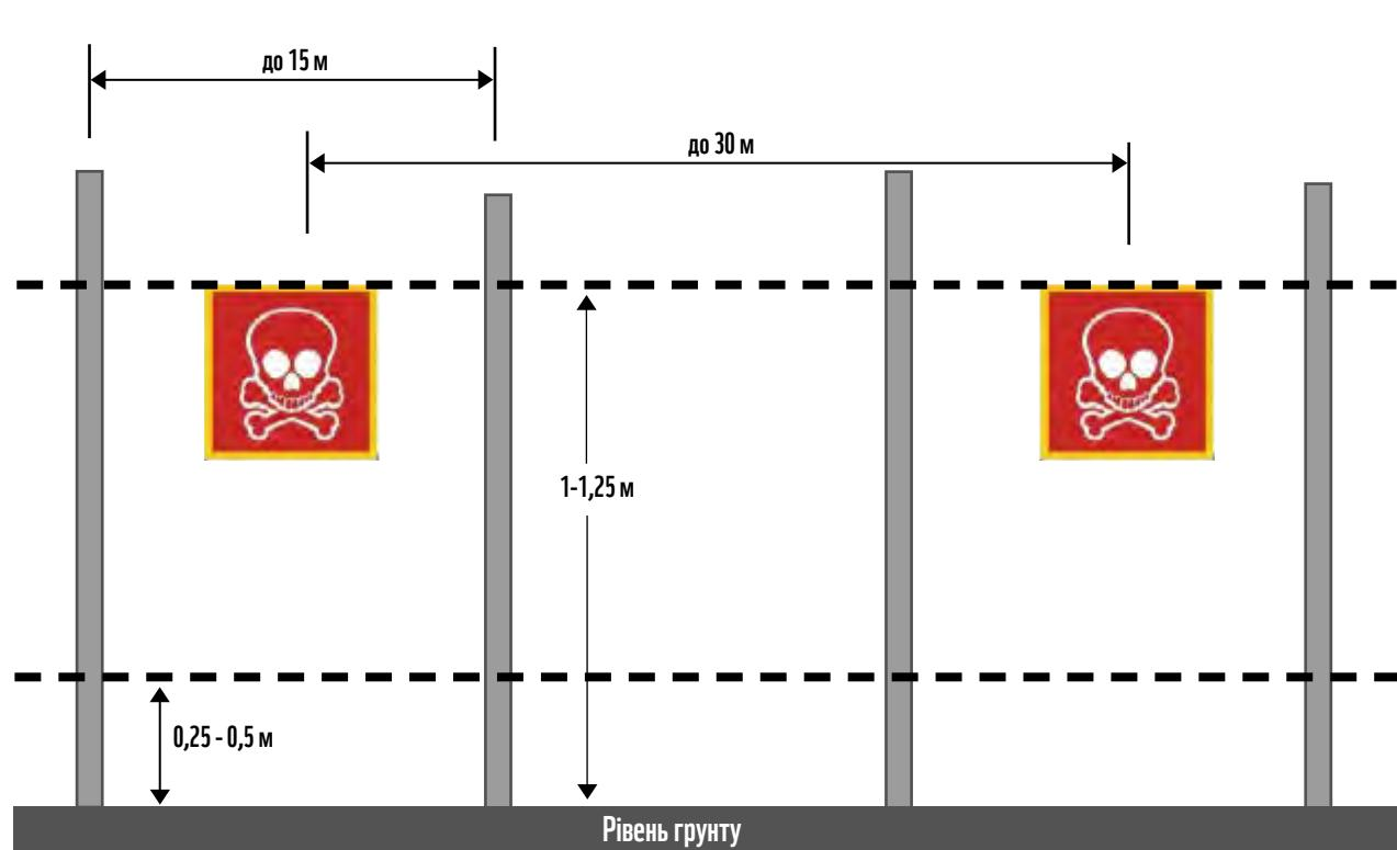
Рис. А.1. Зразок, розміри попереджувального знака та відстані встановлення
