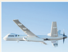
Die Nasa-Drohne „Ikhana“ mit Infrarotsensorik unter dem Flügel verschafft Überblick über Waldbrände. Foto: Nasa
