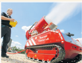
Unbemannte Löschroboter (im Bild Rechner's LUF 60) sollen direkt zu den Brandherden vordringen. Foto: dpa
