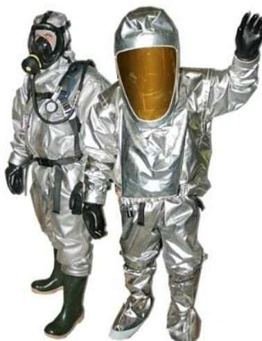
Aparat za disanje sa komprimiranim vazduhom se nosi iznad odela; vreme rada može se povećati brzom promenom cilindara. Odelo štiti od topotnih fluksa do 14 kW/m<sup>2</sup> (najmanje 180 sekundi).
