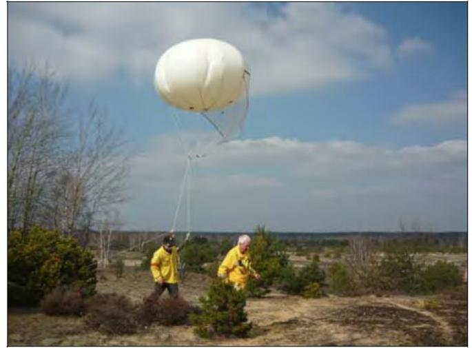
**Slike 2.27 do 2.28.** Bespilotni vazdušni sistemi (BVS), uključujući fiksne i helikopterske dronove ili privezane balone, su preduslov za upravljanje incidentnim šumskim požarama ili propisanog spaljivanja na kontaminiranim terenima u Nemačkoj. Prenos vazdušnih posmatranja vatre u realnom vremenu dozvoljava upravniku situacije da kontroliše operaciju sa sigurne udaljenosti i usmerava blindirana ili bezposadna kopnena vozila na lokaciju požara. Fotografije: GFMC.
