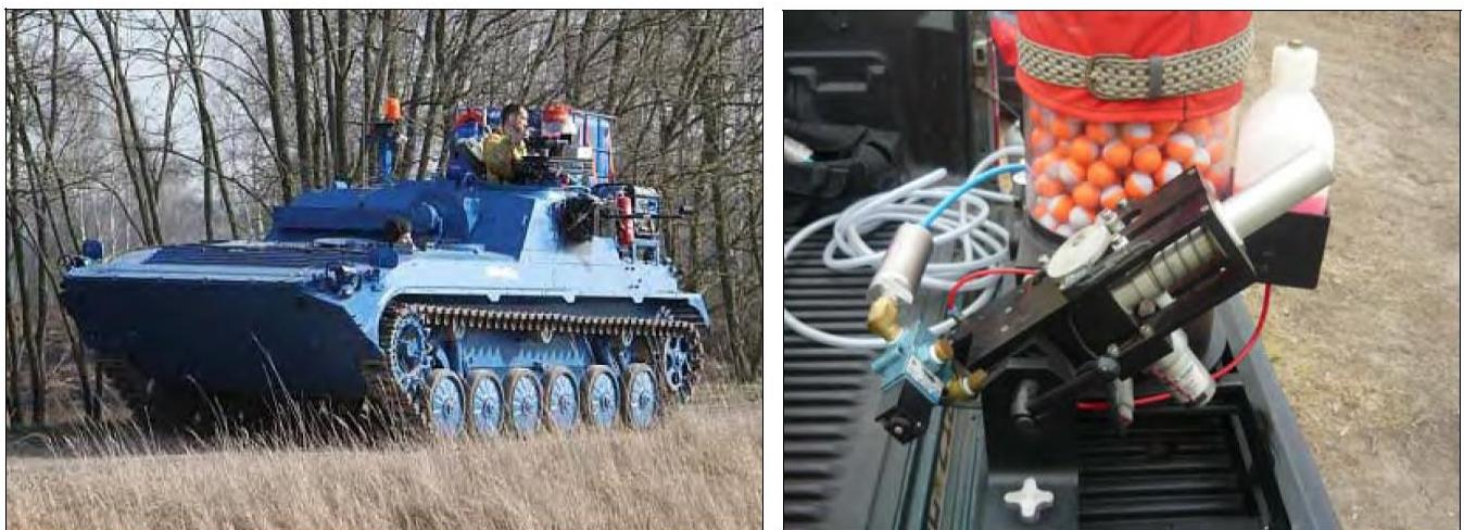
**Slike 2.22 do 2.23.** Konvertovani BMP-OT-R5 tenk za upotrebu kao oklopni tenk za paljenje, opremljen Pyroshot Green Dragon®-om za paljenje zapaljivih uređaja za postavljanje propisanih ili pozadinskih požara. Fotografije: GFMC.
