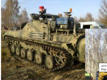
„Neuland“: Der Zündpanzer mit Fern- und Nahzündgerät, Kommunikationseinrichtungen, „Sicht nach außen“ und zusätzlichem Löschwasser
