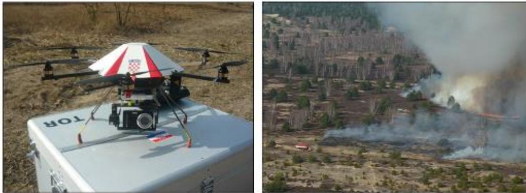
Slika 24-25: Mali bežični drone tipa CT Bee 6B upravlja partner projekta Crvena tipka d.o.o. (Hrvatska) pružio je slike u realnom vremenu (fotografije i video snimke) operacija propisanog spaljivanja koje omogućavaju sigurno i precizno paljenje i suzbijanje izmicajućih požara (Fotografije: projektni tim).
