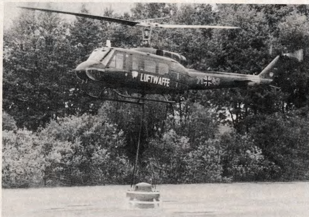
Abb. 2: Wasserübernahme vom Gewässer mit SMOKEY-Behälter.
