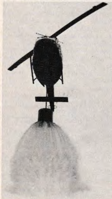
Abb. 1: Hubschrauber Bell UH 1 D mit QD-Behälter beim Wasserabwurf.
