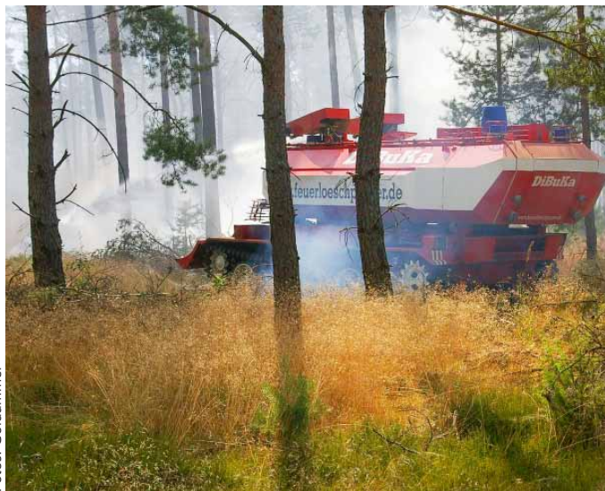
Der Einsatz des Löschanzers vom Typs SPOT-55 empfiehlt sich u. A. bei der Bekämpfung von Bränden in munitionsbelasteten Waldflächen.
