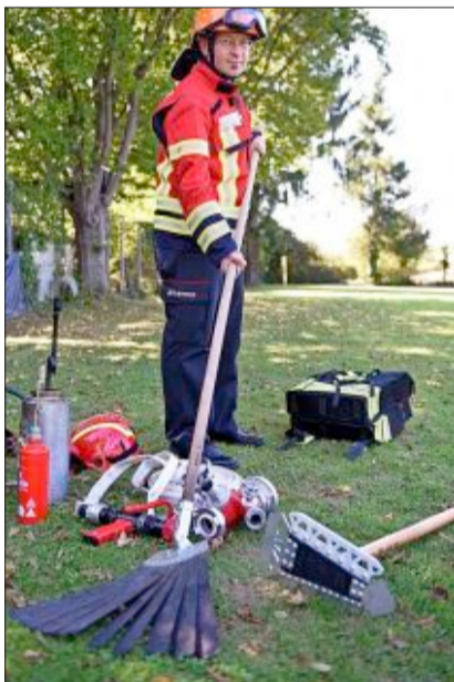
Werkzeuge gegen Waldbrand: Thomas Lehmann von der Feuerwehr Waltershofen mit der Feuerpatsche (links). Rechts: Mit Feuerkannen lösch man nicht, sondern zündelt – für kontrollierte Gegenfeuer. FOTOS: R. EGGSTEIN
