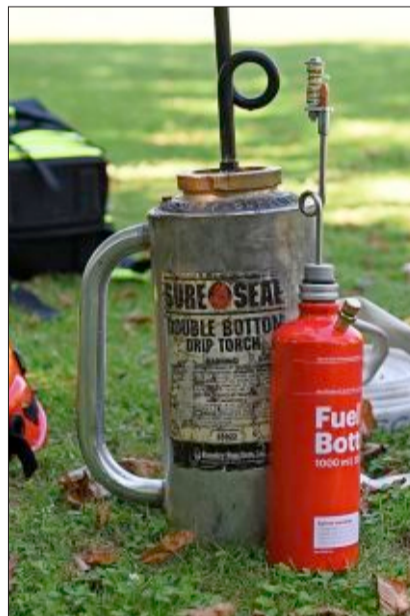
Werkzeuge gegen Waldbrand: Thomas Lehmann von der Feuerwehr Waltershofen mit der Feuerpatsche (links). Rechts: Mit Feuerkannen lösch man nicht, sondern zündelt – für kontrollierte Gegenfeuer. FOTOS: R. EGGSTEIN
