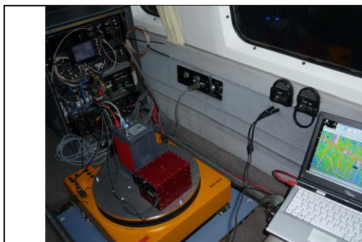
Abb. 3. Integration eines Thermalinfrarotsensors in ein Messflugzeug (Beispiel einer einfacheren Aufnahmekonfiguration)
