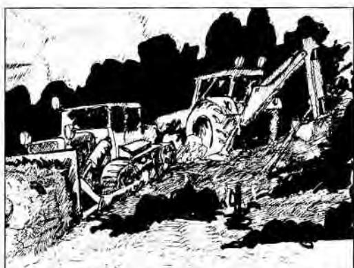
Прокладывать бульдозером минполосу поперек склона, выше или ниже пожара, не рекомендуется. На склонах крутизной более 35% производительность бульдозера обычно сильно падает.
