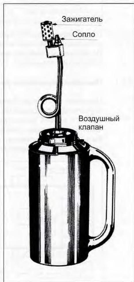
выливается параллельно направлению движения оператора. Чтобы получить большой радиус действия, ЗАКД надо качнуть вперед и назад движением кисти руки. ЗАКД должен полностью остыть после окончания работы. Для перевозки на транспорте имеются специальные держатели.
