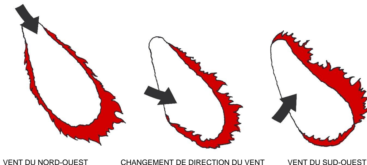
Illustration 1.9. Effet du changement de la direction du vent sur le feu
