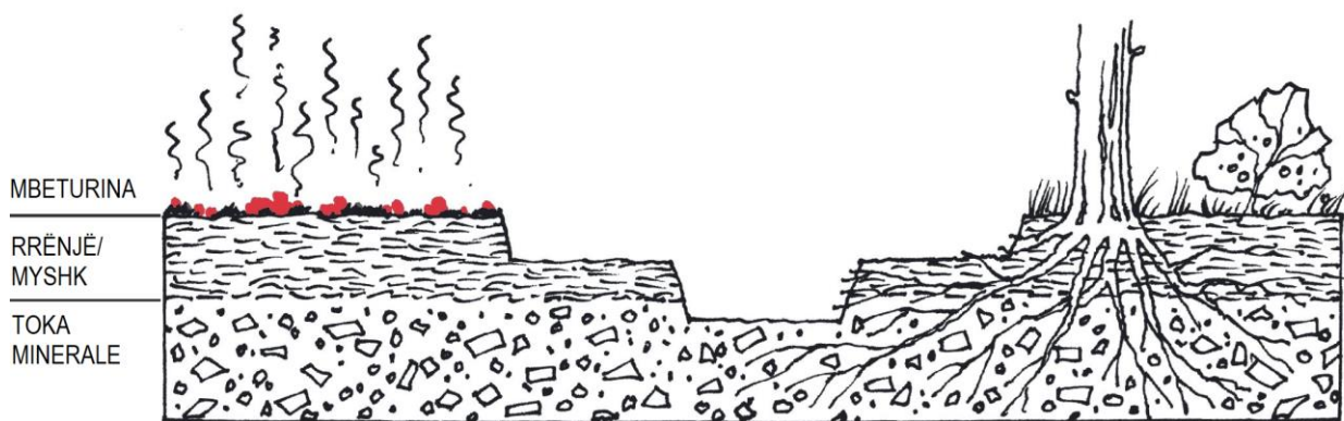
Ilustrimi 3.3 Ndërtimi i linjës së zjarrit - Prerja / veçimi i karburanteve dhe zjarri ngulfatur
