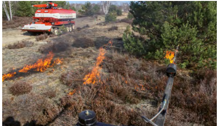
Panzertechnik: Sie stellt die Sicherheit der Einsatzkräfte bei Bränden in UXO-Gebieten sicher. Hier der blaue Zündpanzer beim Kontrollierten Brennen. Der Löschpanzer sichert ab.
