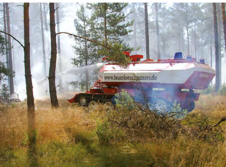
Löschpanzer: Sie sind die ideale Wahl bei Bränden in munitionsbelasteten Wäldern und Offenland.
