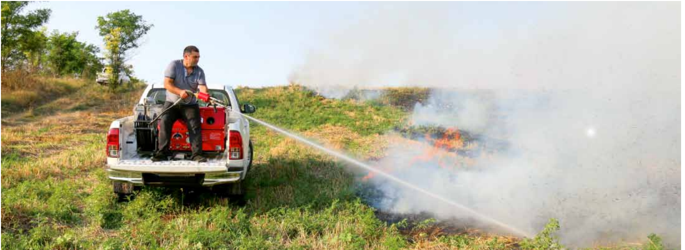
Beispiel des Aufbaus einer leichten, geländegängigen und leistungsfähigen Feuerlöschleinheit auf einem Standard-Fahrzeug der Forstverwaltung und des Landschaftspflegeverbands in Khaketi, Georgien (Südkaucasus).
