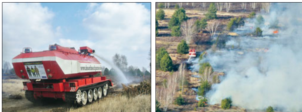
Abb. 11a-b: Feuerlöschpanzer SPOT-55 (DTF/DiBuKa) im Einsatz am 22. März 2012. Die Luftaufnahme während des Brennens zeigt den Löschpanzer beim Ablösen des Feuers am beräumten Sicherungstreifen entlang der Westflanke von Versuchsfläche 10 (Fotos: Brenn-Team/Crvena tipka d.o.o.).
