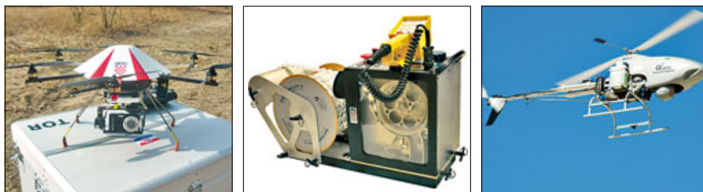
Abb. 12a-c: Der ferngesteuerte unbemannte Kleinhubschrauber vom Typ CT Bee 6B (Abb. 12a) übernahm bei den ersten Versuchen die Darstellung des Echtzeit-Lagebilds und damit die Steuerung der Panzer, der ggf. erforderlichen Nachzündung und der Absicherung (Dirigierung des Löschpanzers); ein weiteres Fernzündgerät vom Typ Raindance R2 ® (Abb. 12b) wird derzeit auf einer etwas schwereren Plattform wie dem SNIPER XL UAV System ® (Abb. 12c) eingebaut und soll 2012-13 erstmalig getestet werden (Fotos: Arbeitsgruppe Feuerökologie, Alpha Unmanned Systems und Raindance Systems).
