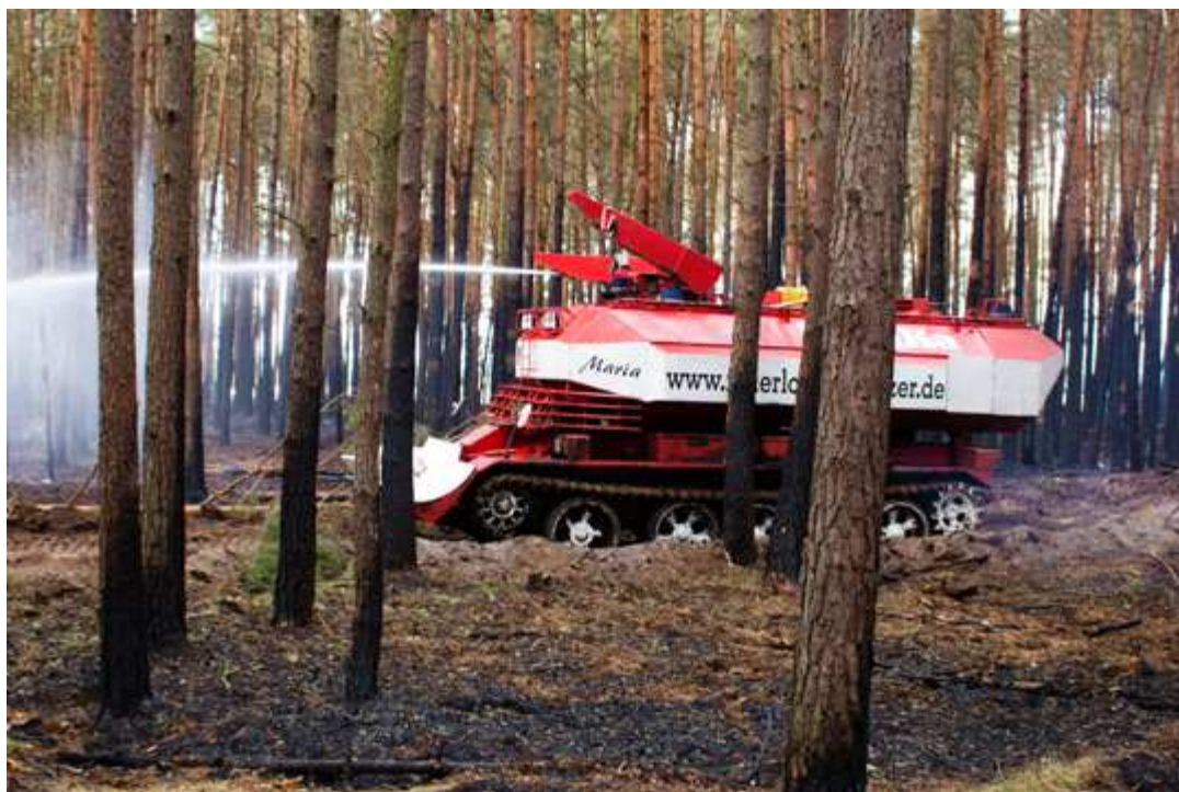
Personal schützen: Gemeinsam mit einem Unternehmen hat das Global Fire Monitoring Center einen Löschpanzer entwickelt, mit dem sich Feuer auf munitionsbelasteten Standorten sicher bekämpfen lässt. Foto: DiBuKa
