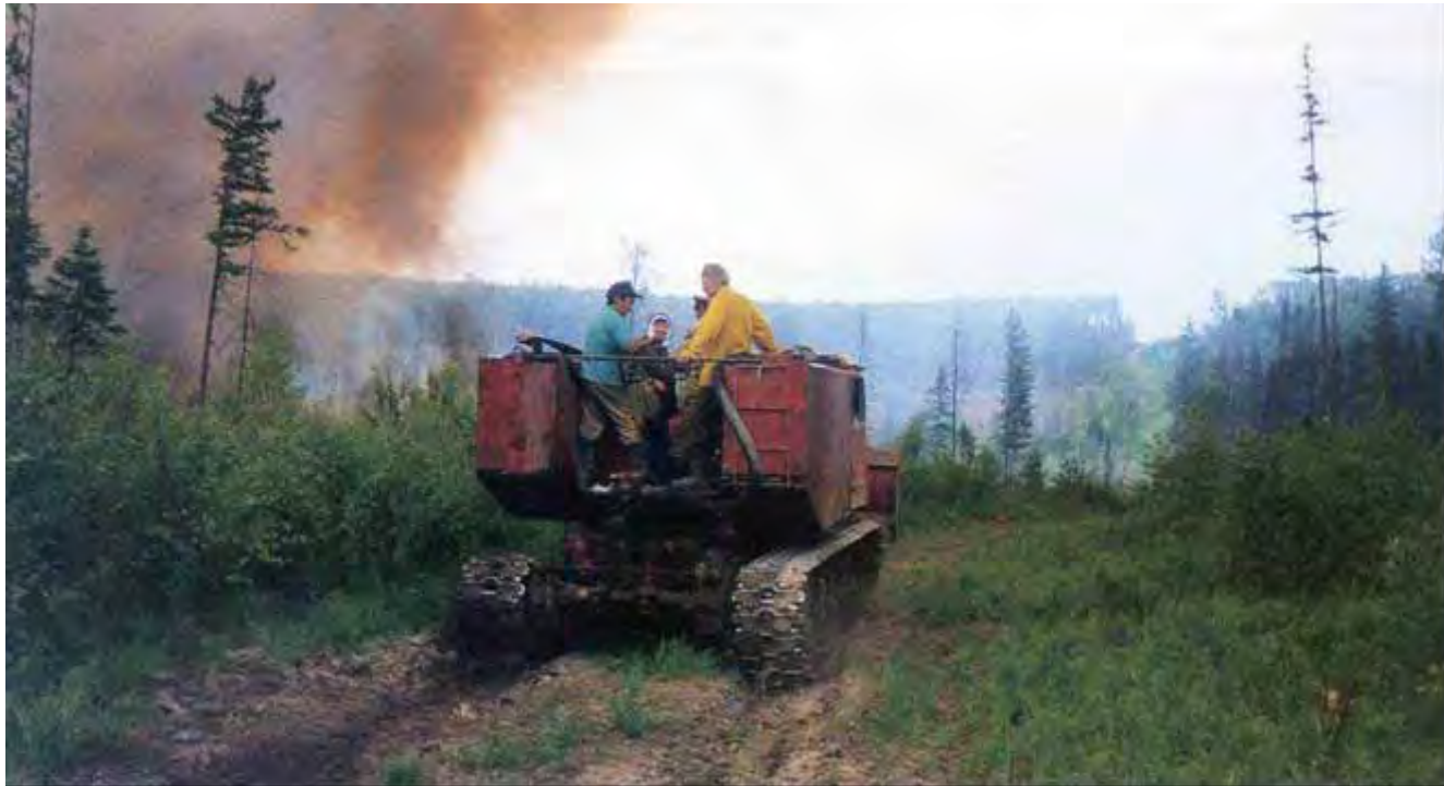
ФОТО 16. Для сдерживания огня, локализации и дотушивания очагов горения наиболее эффективно применение пожарного трактора ТЛП-4.
