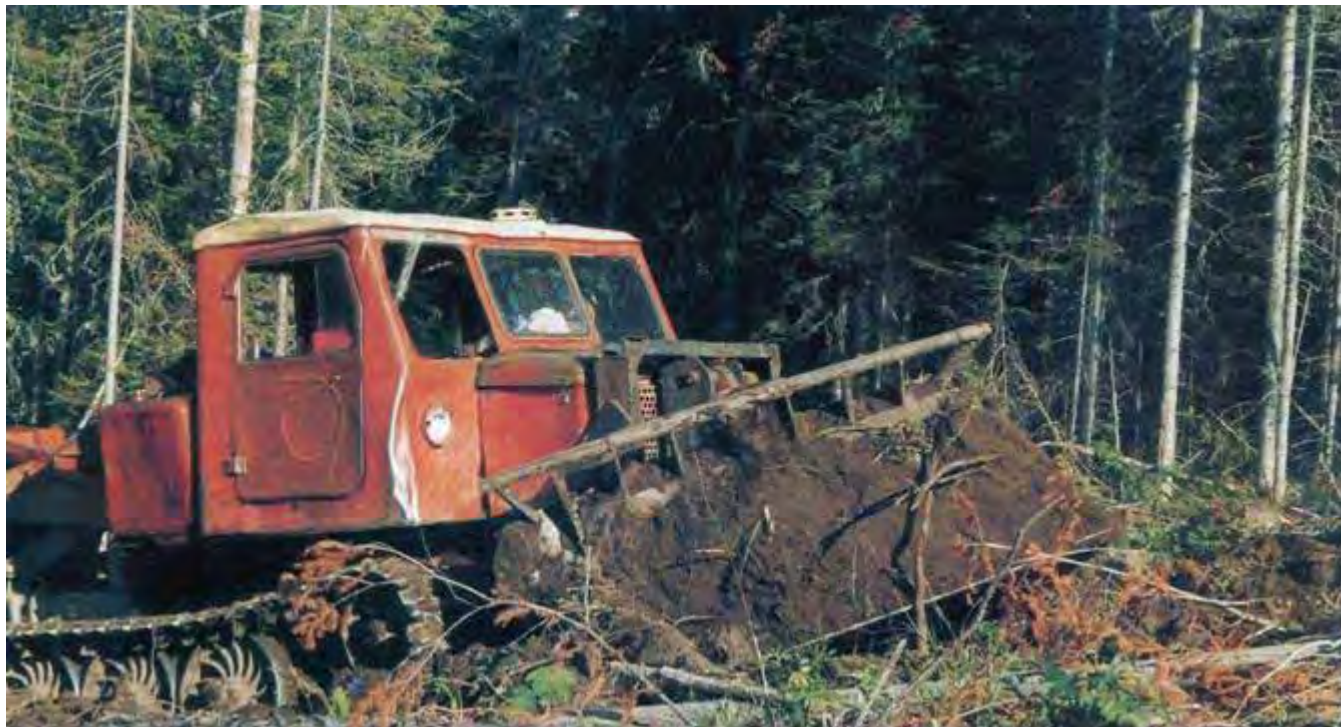
ФОТО 14. Трелевочный трактор с клином прокладывает минполосы, раздвигая крупные порубочные остатки в стороны, не образуя кучи и валы, где горение сохраняется длительное время.
